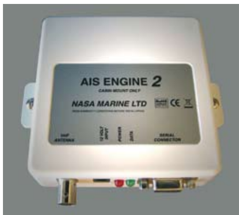
Los barcos que utilicen un PC o laptop sin USB agradecerán una caja negra AIS con puerto de serie
