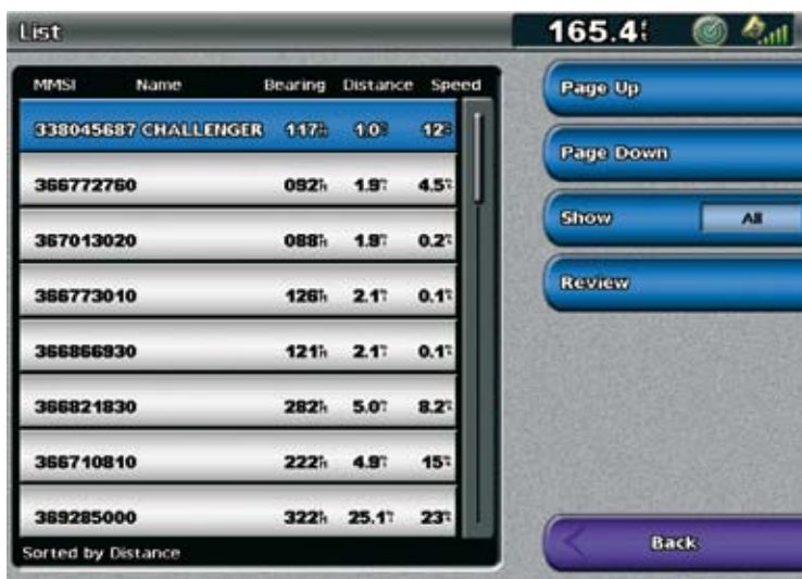
Dos presentaciones del transceptor Garmin AIS 600 en los plotters de esta marca. La primera con el listado de barcos por MMSI, nombre, marcación, distancia y velocidad. La segunda sobrepone los ecos AIS en la pantalla de plotter
