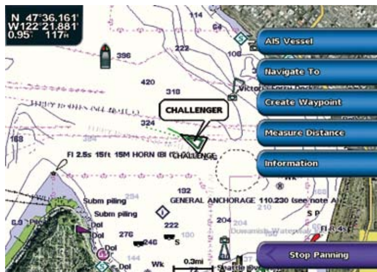
Dos presentaciones del transceptor Garmin AIS 600 en los plotters de esta marca. La primera con el listado de barcos por MMSI, nombre, marcación, distancia y velocidad. La segunda sobrepone los ecos AIS en la pantalla de plotter
