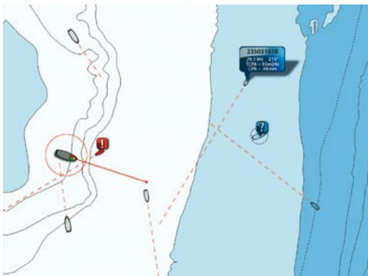
La iconografía de ploteo AIS del Geonav G12 utiliza colores, parpadeos, cuadros de datos o líneas de rumbo para reflejar de forma clara los riesgos de abordaje
