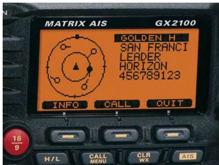
VHF con AIS incorporado Standard Horizon GX-2100 con tecla de llamada directa mediante DSC
