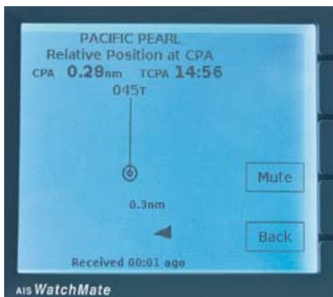
En esta escueta, pero clara presentación del WatchMate, se reflejan el CPA, el TCPA y la posición relativa de ambos barcos
